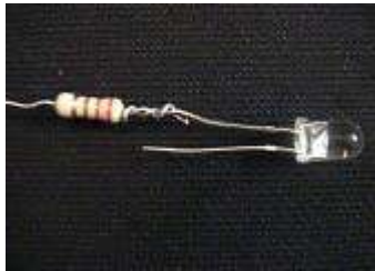
Resistor conectado ao positivo do LED
