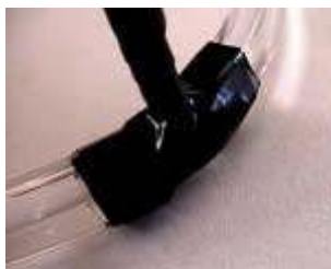
Fita isolante segurando e protegendo os LEDs
